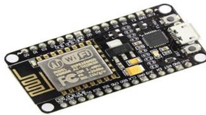
FIGURE 8. NodeMCU ESP8266 module
